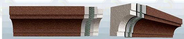
■ EPS 造型表面+玻纤网抹面胶浆增强防护面层+饰面层+罩面层
